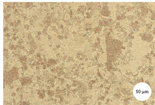
Schliffbild CADgold 84 LaserMelting
