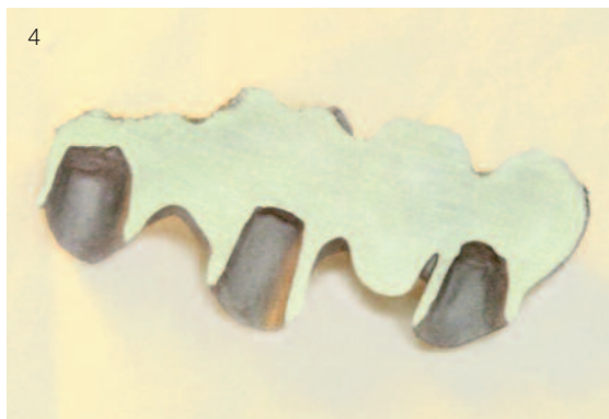
Abb. 4 Schliffbild einer massiven Brücke, die im SLM-Verfahren hergestellt wurde. Das Gefüge ist trotz der massiven Konstruktion homogen
