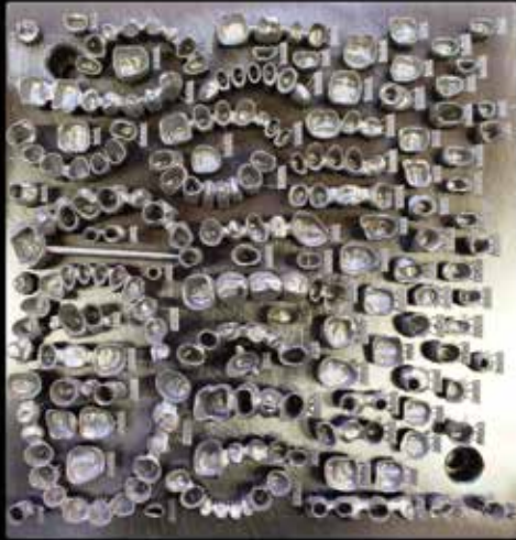
Laser-Platte mit unterschiedlichsten per Laserdrucker hergestellten Gerüsten
