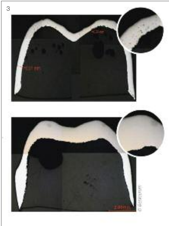
Abb. 3 Eine hohe Präzision und der Ausschluss von Porositäten erreicht CADdent durch die Lasermelting-Technologie
