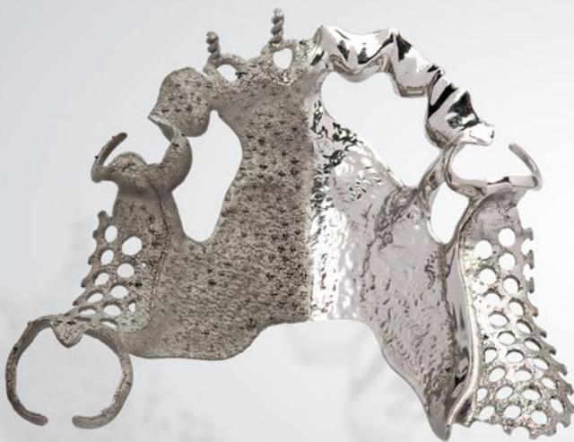
**03** Für diese Abbildung wurden die Supports des Modellgusses auf der linken Seite nicht verschliffen, auf der rechten Seite hingegen verschliffen und poliert.
