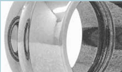
**7** DLyte améliore l'asymétrie de surface négative (RSK) qui augmente la surface de contact du palier (permettant une distribution uniforme du film de lubrifiant), tout en améliorant le rapport de palier et réduisant le frottement entre les pièces.
