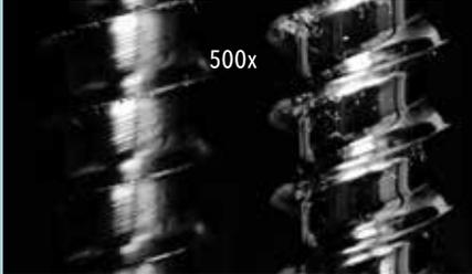
**1** DLyte obtient des **résultats homogènes sur toute la surface** et élimine les micro-rayures. Le système fonctionne efficacement au niveau micro et macroscopique.
